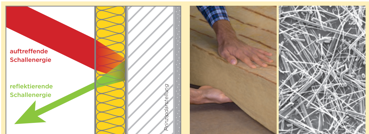
Schallwellen treffen in den Dämmstoff und reiben sich in der Wirrlage des Dämmstoffgefüges an den Fasern. Dadurch verwandelt sich ein erster Teil des Schalls (bzw. der mechanischen Energie) in Wärme.
