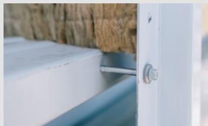
Für die Montage der Außenschale mit dem Systembefestiger **Metac WSB** die Außenschale vorbohren, Schraube einschrauben, fertig. Für die Montage mit **Metac WSB-PLUS-RLR** mit Rechts-Links-Rechts-Technologie ist kein Vorbohren der Außenschale nötig.
