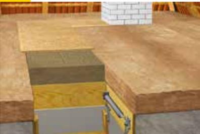
Laufwege werden mit Topdec Loft und einem Gehbelag (z.B. Holzspanplatten, Dicke  $\geq 13$  mm für gelegentliches Begehen) ausgeführt, die restliche Fläche wird mit Topdec Deckenfilzen ausgelegt.
