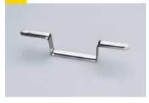
Für sicheren Halt liegt in jeder Rolle Integra UKF-032 in 30 mm und 40 mm ein Beutel Integra UMB Montagebügel kostenlos bei. Integra UKF-032 in 60 mm bzw. Integra UKF-035 in 50 mm Dicke klemmen bis zu einem Lattenabstand von max. 500 mm. Somit sind keine Befestiger erforderlich.
