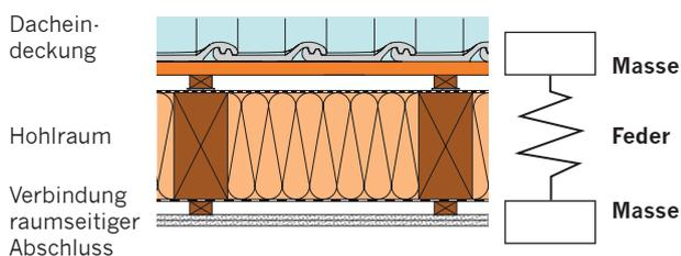
Grundsätzlich hängt das Luftschalldämmmaß, sowohl für Zwischensparren- als auch Aufsparrendämmung von folgenden Einflussfaktoren ab:
