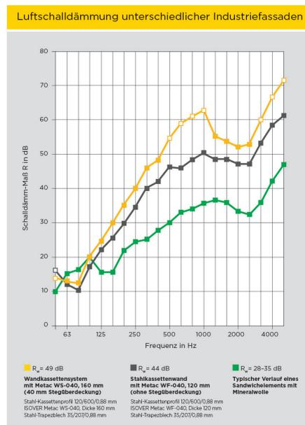
Aus akustischer Sicht schneidet das Wandkassettenystem mit 40 mm starker Stegüberdeckung in allen Frequenzbereichen besser ab als die klassische Stahlkassettenwand ohne Stegüberdeckung. Das spiegelt sich auch in der Einzahlangabe nach DIN EN ISO 717 wider:
