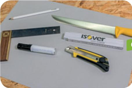
6 Für die Zuschnitte der jeweiligen Dämmstoffkeile helfen Schablonen. Benötigte Materialien sind: Karton, Bleistift, Winkel, Metermaß, Cutter, dicker Filzstift, Dämmstoffmesser.
