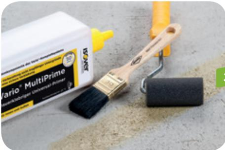
Primer mittels Schaumwalze oder Pinsel gleichmäßig auftragen. Bei stark saugenden Untergründen Vorgang wiederholen. Die Oberfläche ist dauerklebrig und sollte bis zum Anschluss der Klimamembran vor Staub geschützt werden. Vor der Anschlussverklebung muss der Primer vollständig eingezogen sein.
