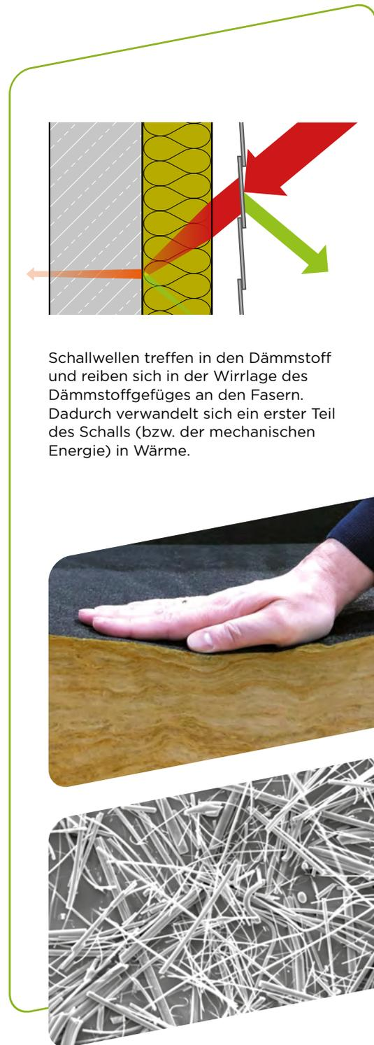
Schallwellen treffen in den Dämmstoff und reiben sich in der Wirrlage des Dämmstoffgefüges an den Fasern. Dadurch verwandelt sich ein erster Teil des Schalls (bzw. der mechanischen Energie) in Wärme.
